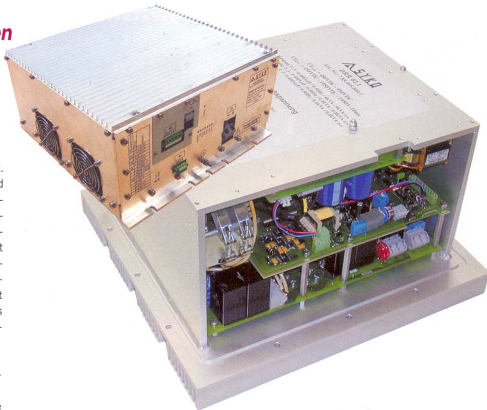
Wechselrichter, um aus der Fahrzeugbatterie oder dem Hochvoltnetz Wechselspannungen (230V / 50Hz oder Drehstrom 400V / 50Hz) für Werkzeuge und Anlagen zu erzeugen.
