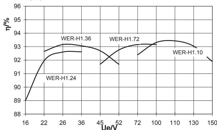
Auf Fahrzeugen der mobilen Anwendung werden 1Ph/2Ph-Batterie-Wechselrichter zur Versorgung von Küchengeräten, Pumpen, Lüftern, Steuerungen, Werkzeugen und Fahrgaststeckdosen usw. aus dem Batterie-Bordnetz benötigt. Die Serie **WER.H1** erzeugt einen synthetischen, geregelten, kurzschlussfesten 230V-Sinus mit Leistungen bis stat. 430VA / 500VA dyn.
