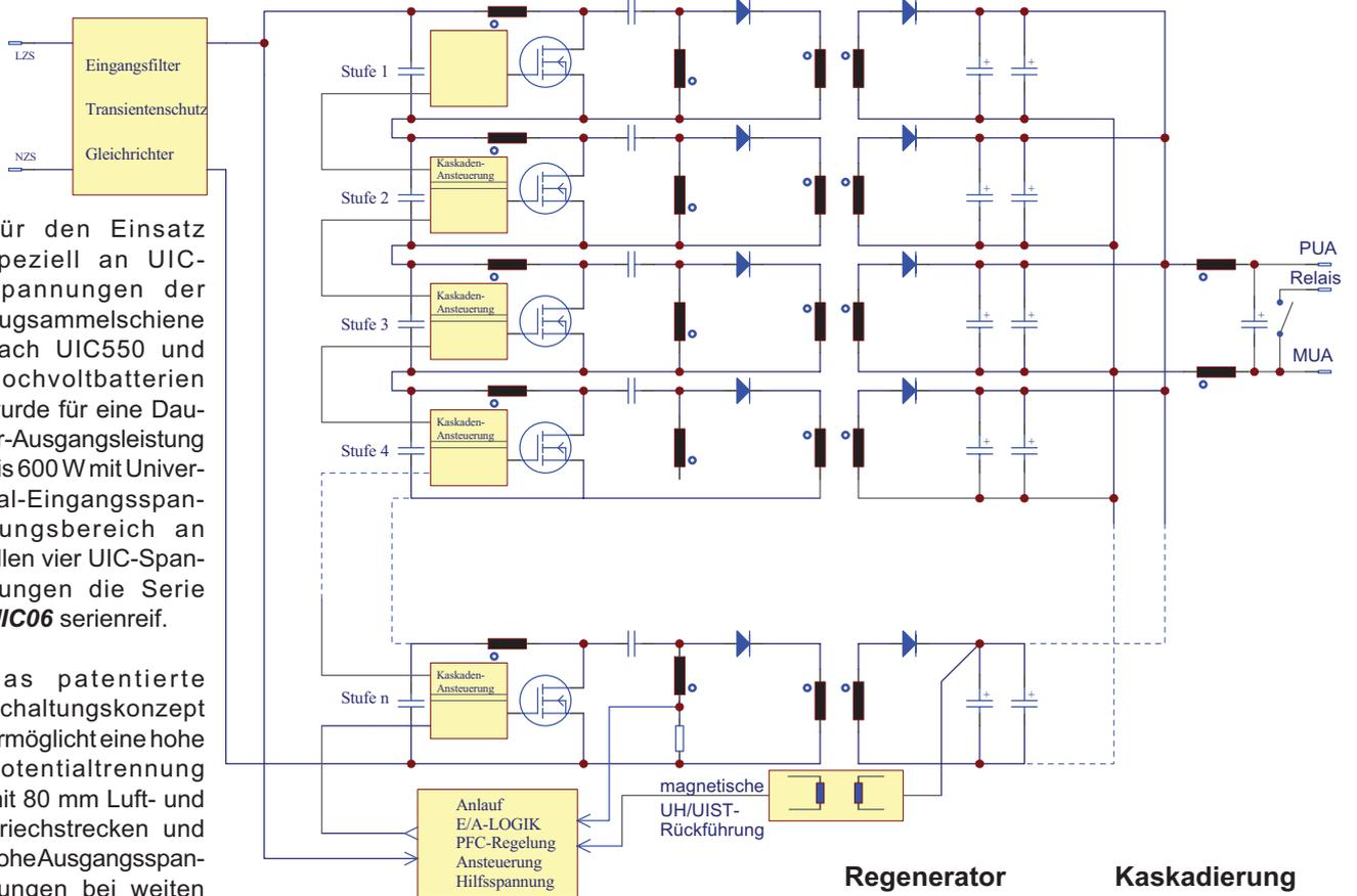
Für den Einsatz speziell an UIC-Spannungen der Zugsammelschiene nach UIC550 und Hochvoltbatterien wurde für eine Dauer-Ausgangsleistung bis 600 W mit Universal-Eingangsspannungsbereich an allen vier UIC-Spannungen die Serie **UIC06** serienreif.
