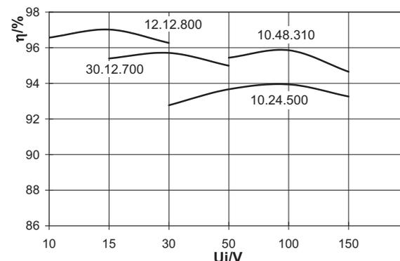
Hochleistungswandler der Serie **QSR** wurden für die Bereitstellung einer nicht potentialgetrennten, konstanten Versorgungsspannung einer Plattform entwickelt. Der extrem hohe Wirkungsgrad bis 98%, die sehr hohe Funktionalität und die angepasste Auswahl der Komponenten erbringen eine sehr hohe Verfügbarkeit über sehr weite Eingangsspannungs- und Temperaturbereiche und bei hohen Chopperströmen. Eine Fremdbelüftung bis 70°C Umgebungstemperatur ist bei freier Konvektion nicht erforderlich.
