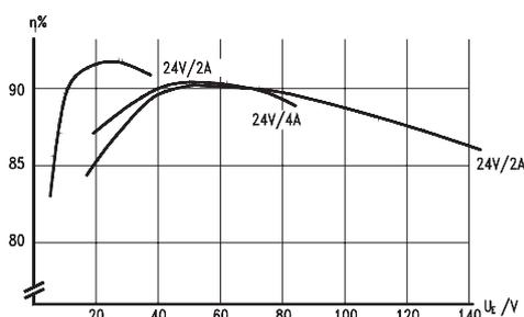
Module der Serie **LSR·V** regenerieren Eingangsspannungsbereiche von 4:1 bis 10:1 in eine potentialgebundene, geregelte, kurzschlußfeste Ausgangsspannung. Hierbei kann die Eingangsspannung niedriger und höher als die geregelte Ausgangsspannung sein. Wandler mit gleicher Ausgangsspannung können parallelgeschaltet werden mit einem Strom-Derating ab 60°C.
